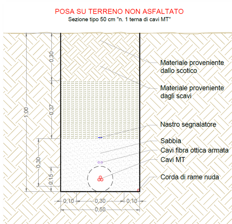
Figura 5-2 - Esempio di posa cavi MT interrati su terreno non asfaltato
