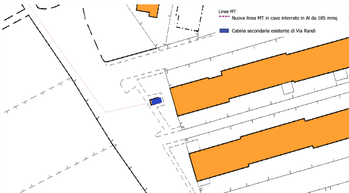
Figura 4-4 - Schema di collegamento linea MT interrata - cabina secondaria via Randi
