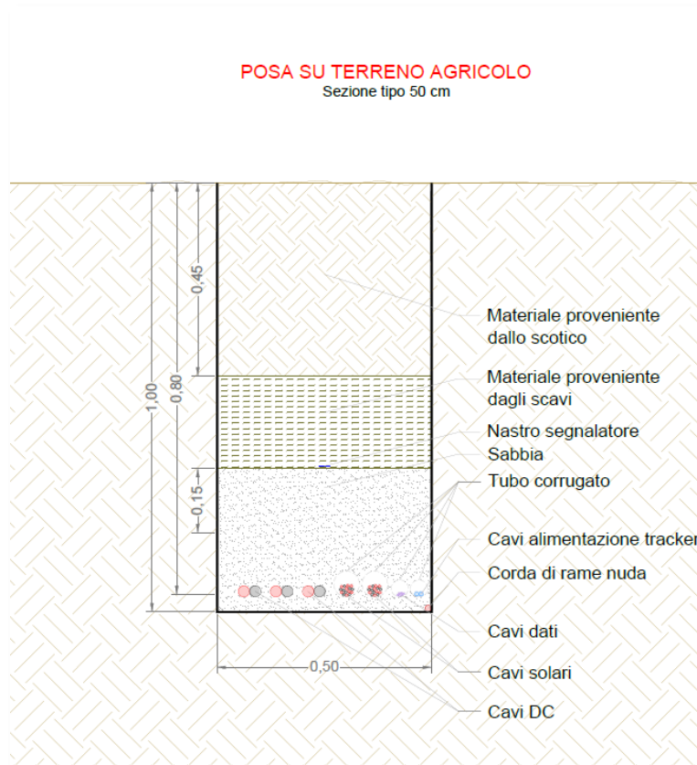
Figura 5-1 - Esempio di posa cavi interrati su terreno agricolo
