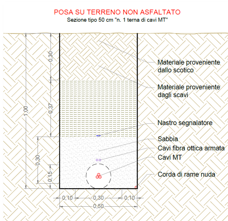
Figura 4-8 - Esempio di posa cavi MT interrati su terreno non asfaltato
