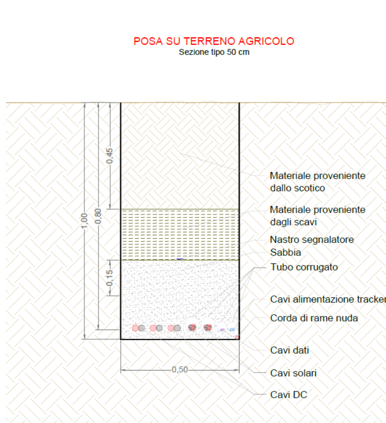
Figura 4-7 - Esempio di posa cavi interrati su terreno agricolo
