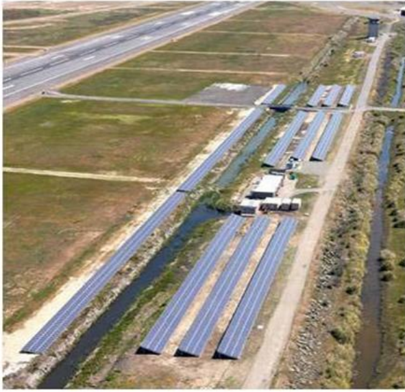
Figura 0-4_ Esempi di impianti fotovoltaici in ambito aeroportuale. La disposizione dei moduli fotovoltaici in prossimità delle piste di atterraggio/decollo non rappresenta un rischio per la sicurezza
