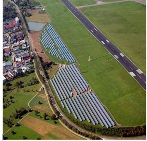
Figura 0-4_ Esempi di impianti fotovoltaici in ambito aeroportuale. La disposizione dei moduli fotovoltaici in prossimità delle piste di atterraggio/decollo non rappresenta un rischio per la sicurezza
