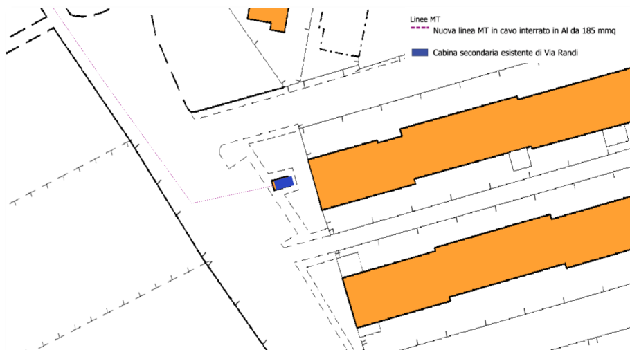
Figura 2-5 - Schema di collegamento linea MT interrata - cabina secondaria via Randi
