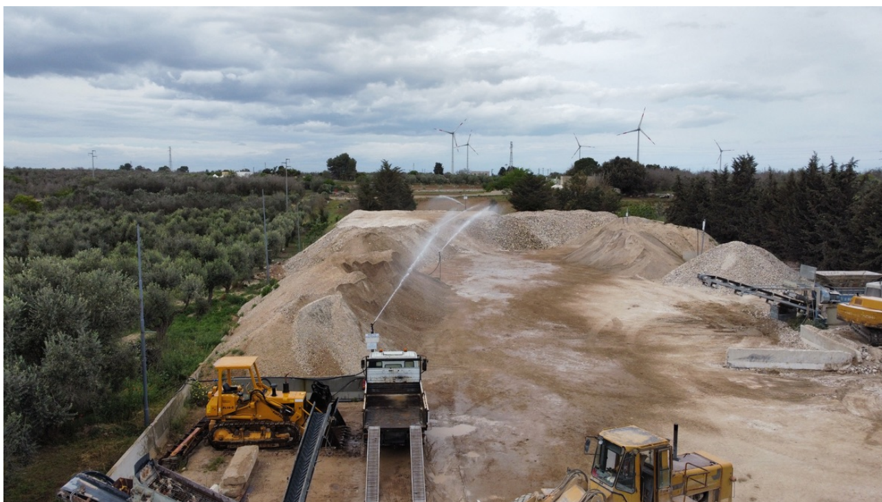
Figura 4-5: impianto abbattimento polveri
