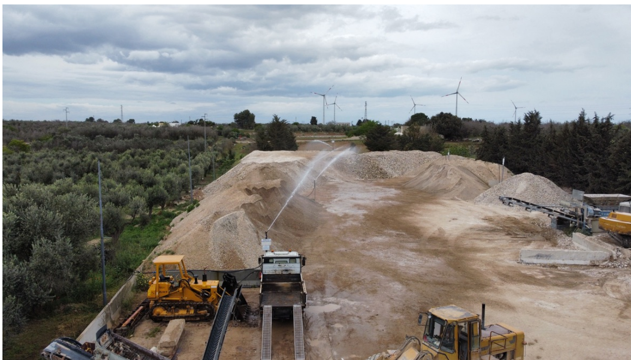
Figura 4-5: impianto abbattimento polveri
