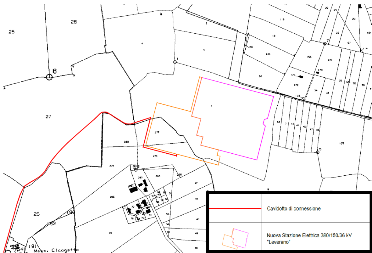
Figura 2. Dettaglio della parte finale del nuovo tracciato di cavidotto da sottoporre a Valutazione Preliminare (lunghezza complessiva 3.768 m).
