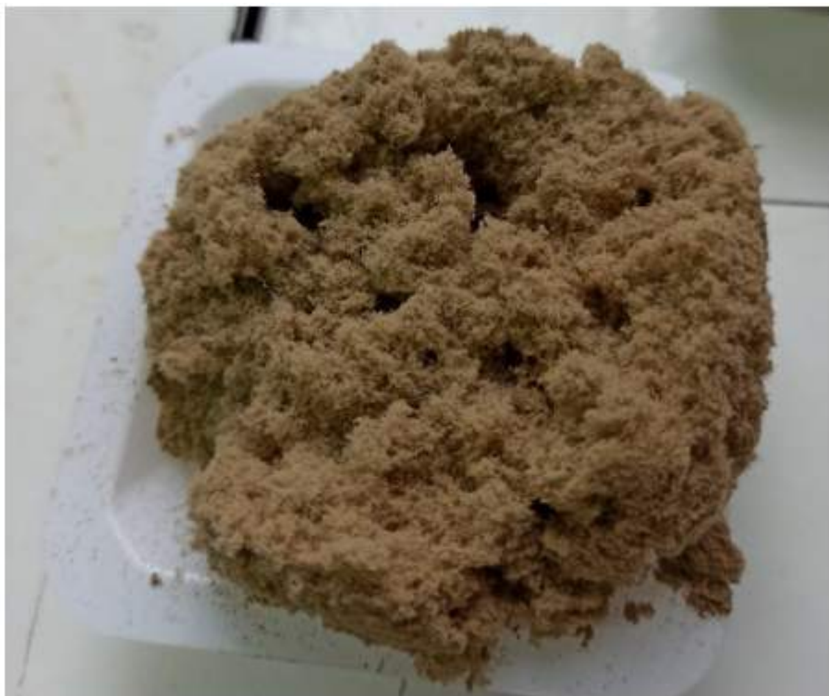
Figura 5: Fanghi cellulosici essiccati e macinati
