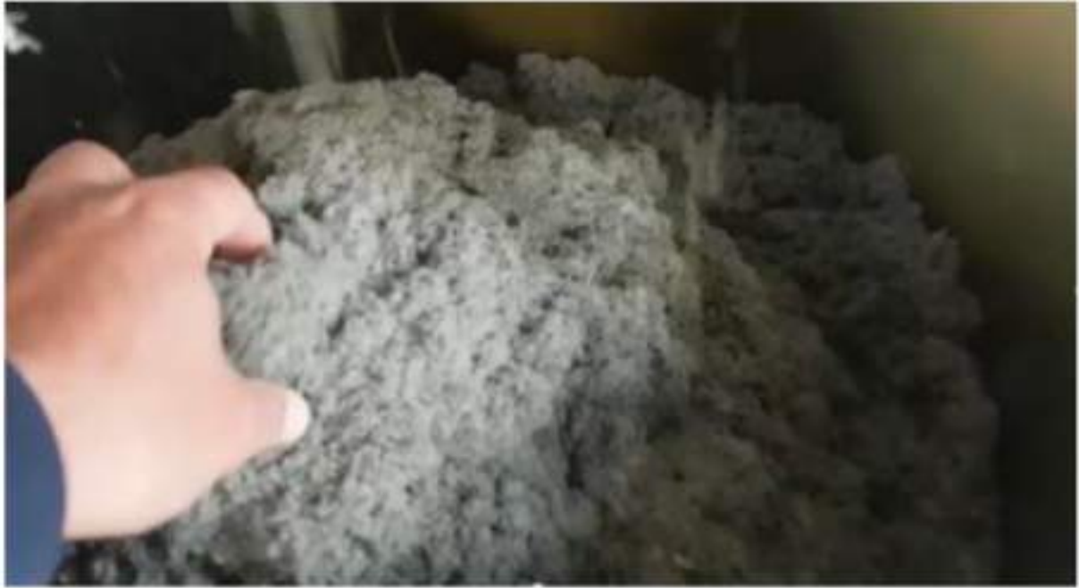
Figura 7: particolare cellulosa in uscita da impianto pilota
