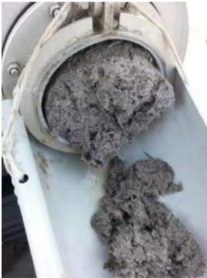
Figura 6: Cellulosa in uscita dall'impianto pilota
