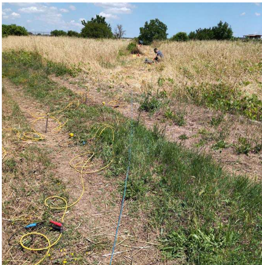
Foto 6- Esecuzione della Tomografia elettrica
