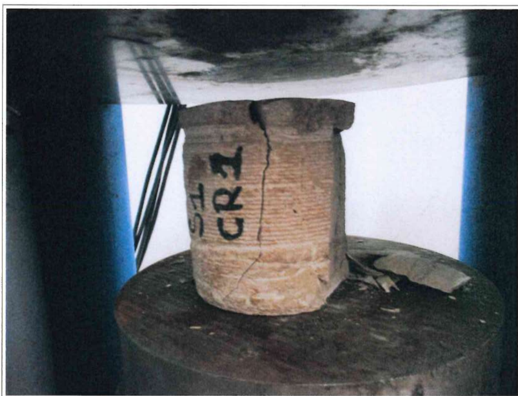
ROTTURA DEL CAMPIONE SOTTOPOSTO A PROVA.
