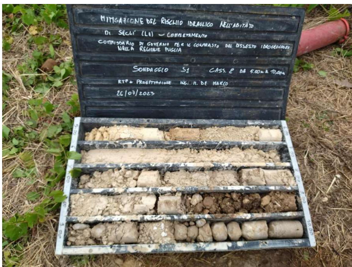
Cassetta catalogatrice n.2 da 5.00 m a 10.00 m (sondaggio S1)
