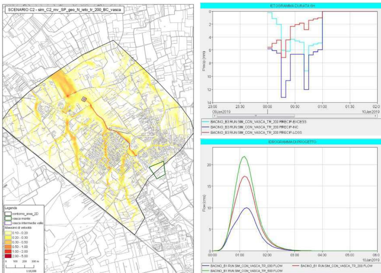
Figura 7 – A sinistra "dominio di calcolo", a destra "ietogramma" in alto e "idrogramma" del bacino B1 in basso
