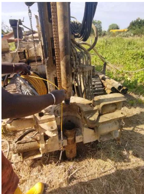
Foto 2 e 3-Esecuzione della prova di permeabilità Lefranc nel tratto tra 2-3 m dal p.c.
