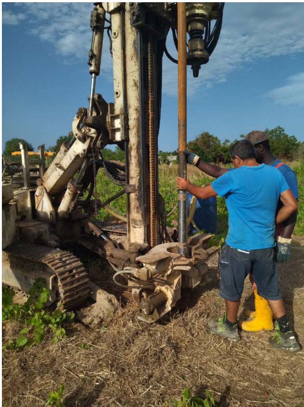
Foto 1 -Esecuzione del prelievo di campione indisturbato con campionatore Shelby
