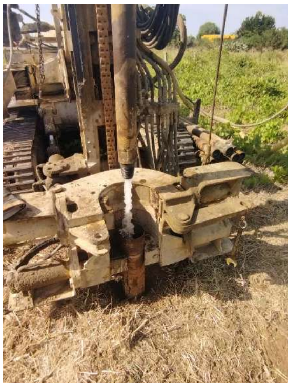
Foto 2 e 3-Esecuzione della prova di permeabilità Lefranc nel tratto tra 2-3 m dal p.c.
