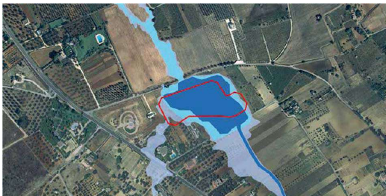
Figura 4 – Perimetrazioni idrauliche in corrispondenza della vasca di laminazione in progetto
