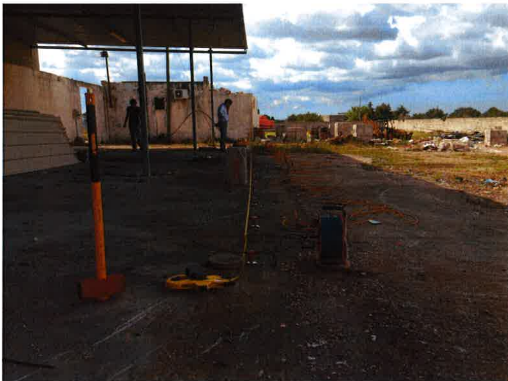
N. 1 prospezione sismica (2-2'), eseguita con il metodo a rifrazione della lunghezza di m 23 nella parte occidentale dell'area d'impronta dell'edificio (vedi immagine seguente);
