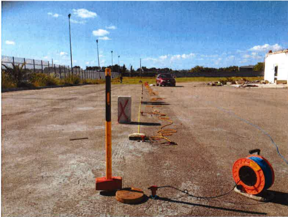
N. 1 prospezione sismica (2-2'), eseguita con il metodo a rifrazione della lunghezza di m 23 nella parte occidentale dell'area d'impronta dell'edificio (vedi immagine seguente);
