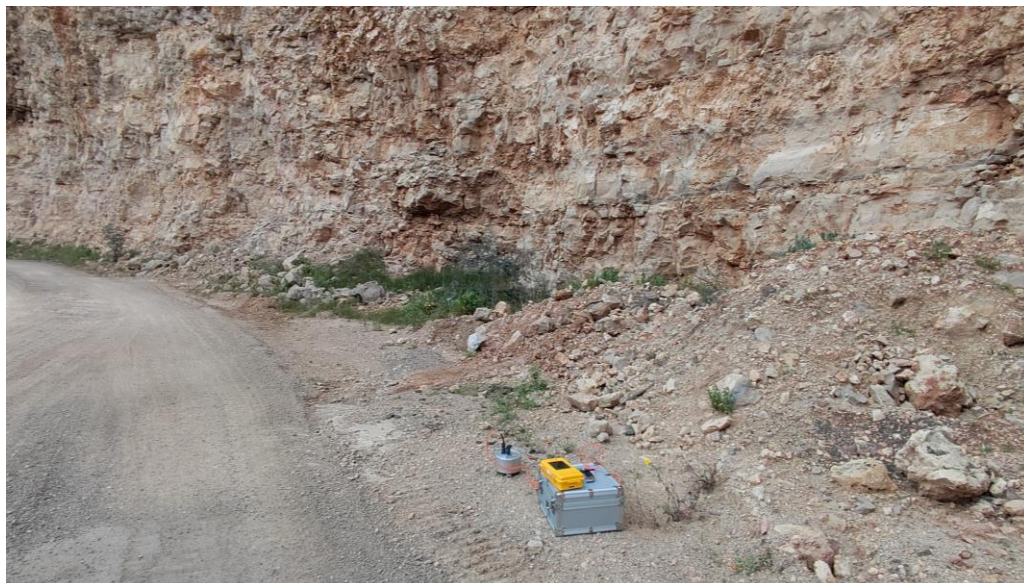
Indagine sismica alla base dei fronti di cava
