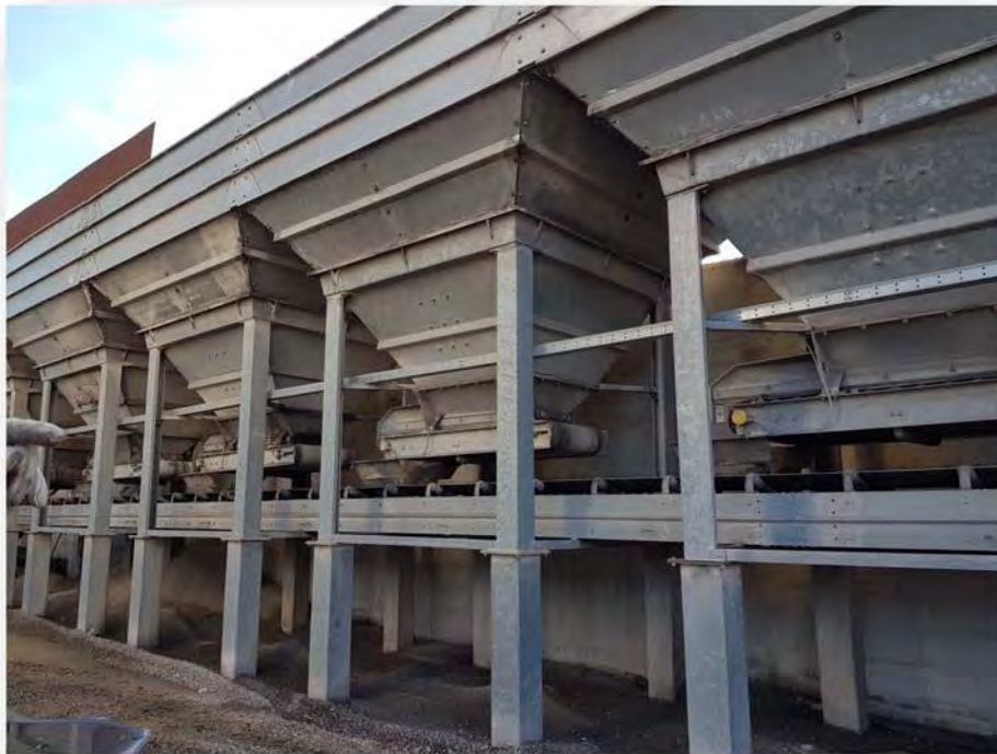
Fig. a Impianto di predosatura ponderale
