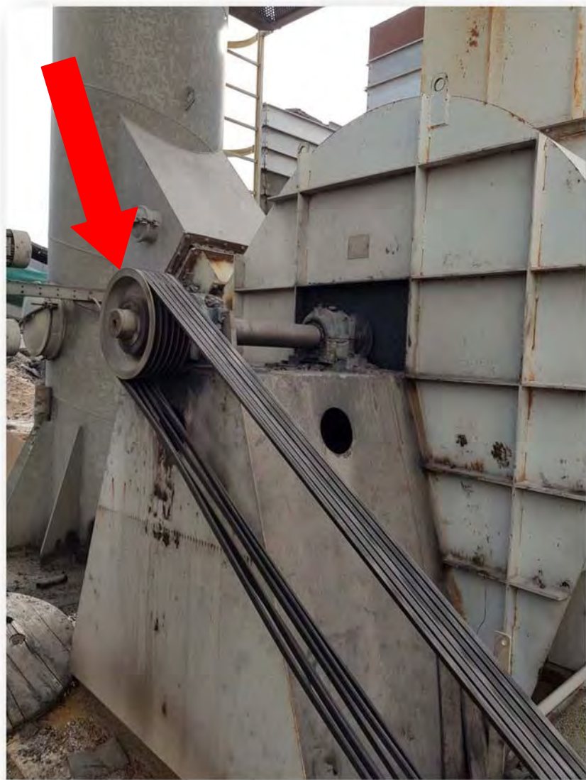
Cinghie trasmissione potenza scoperte
