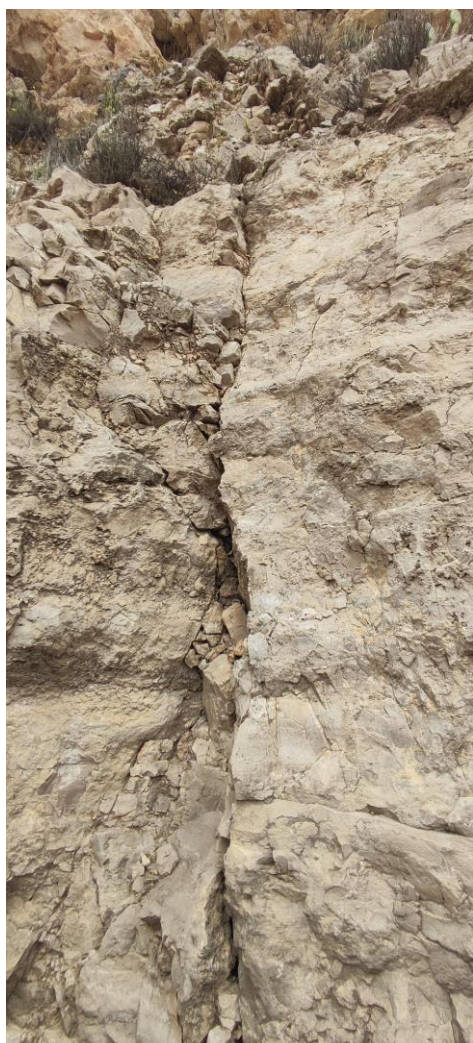
Foto 6 - 7 dettaglio delle fratture principali con inclinazioni prossime a 70-80°
