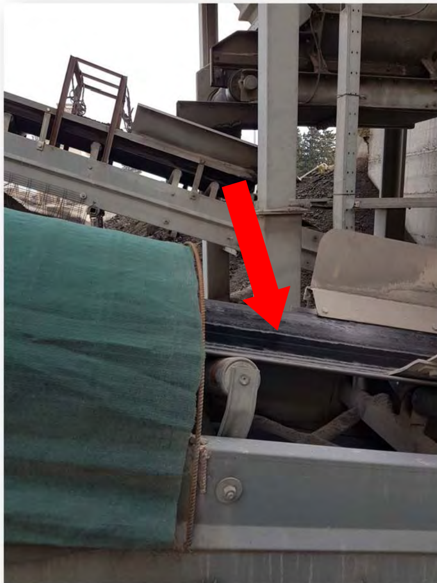
Nastro trasportatore privo di protezione
