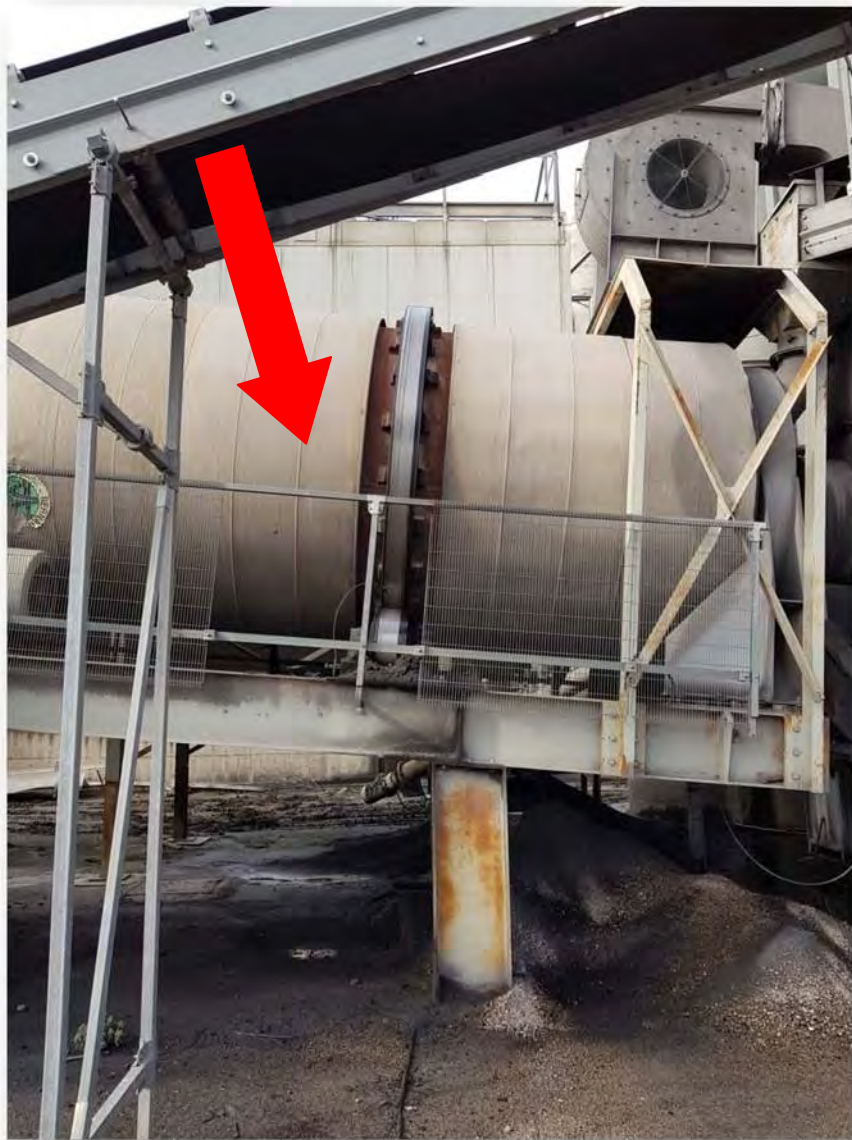
Essiccatore rotativo con parti di cancelletto di protezione mancanti ad altezza d'uomo
