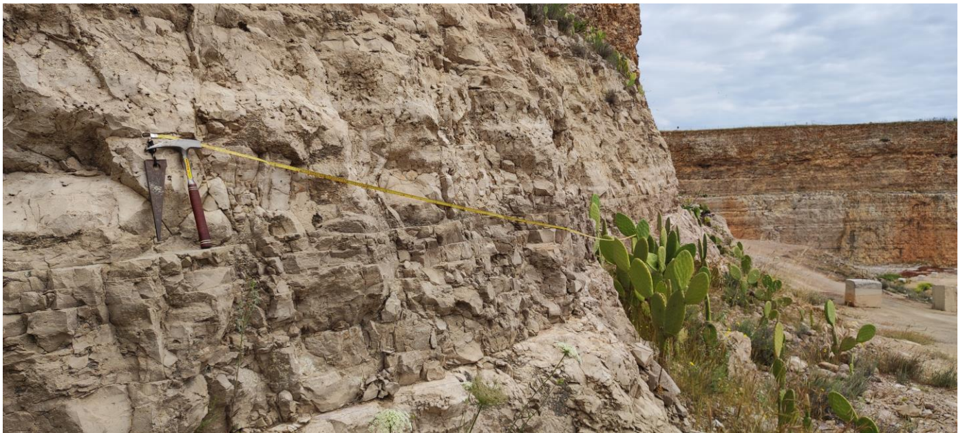
Foto 4 traccia delle scanlines
