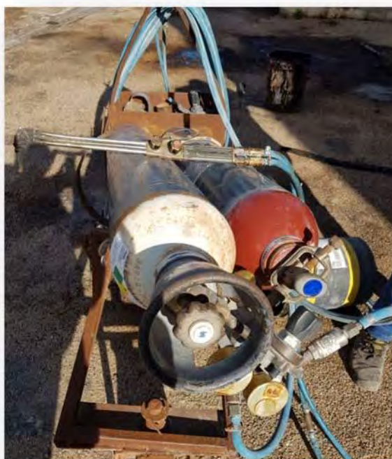
Postazione saldatura taglio ossiacetilenico
