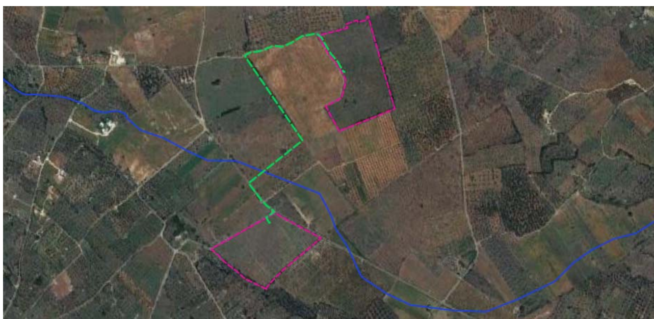
Figura 5 - Particolare della panoramica degli elementi costituenti del progetto, in blu il reticolo idrografico riportato dal wms del DAM, in verde tratteggiato il cavidotto interrato MT di connessione dei due sottocampi
