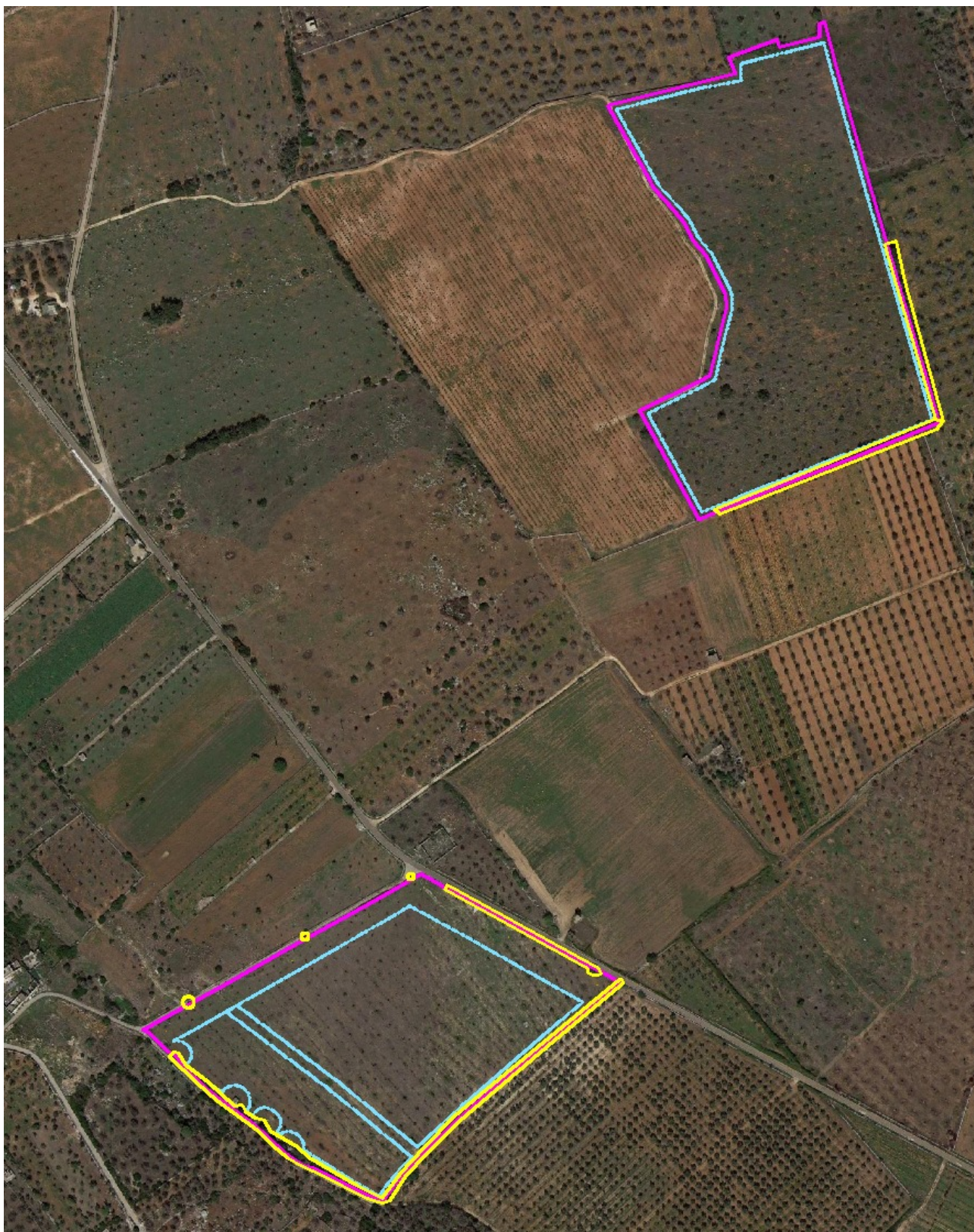
Figura 48: ortofoto stato dei luoghi: in magenta confini catastali, in ciano l'area che racchiude l'impianto FV, in giallo le essenze preservate.
