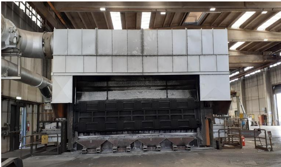
Fig.5 - Forno fusorio monocamera da 25 tonnellate
