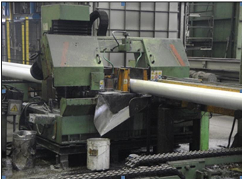
Fig.7 – Impianto spuntatura billette
