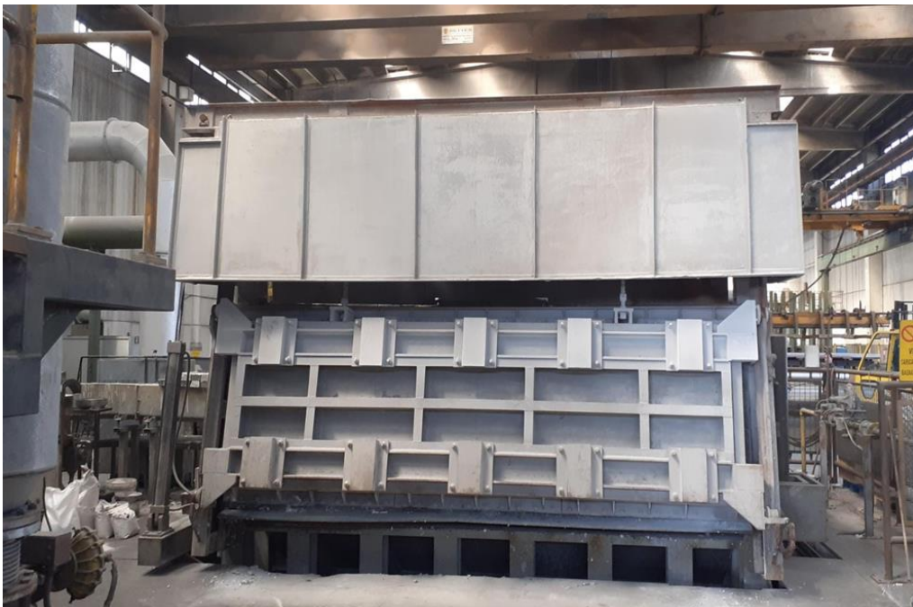
Fig.6 - Forno di attesa da 14 tonnellate
