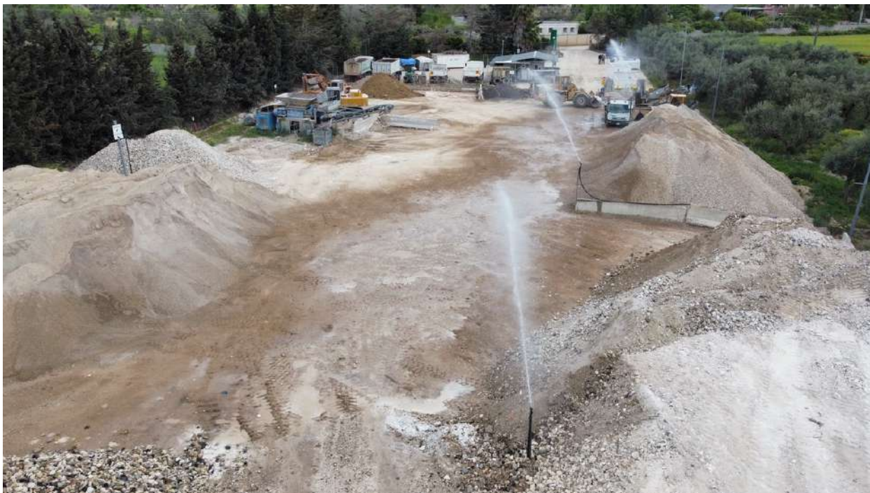
Figura 3: impianto di abbattimento polveri in funzione
